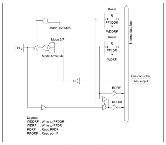
$Figure\ C\text{-}11\ (e)\quad Port\ F\ Block\ Diagram\ (Pin\ PF_4)$
