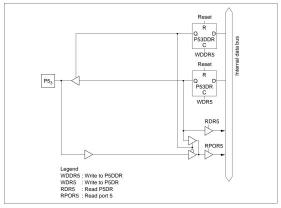
Figure C-5 (d) Port 5 Block Diagram (Pin P5<sub>3</sub>)
