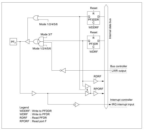
Figure C-11 (d) Port F Block Diagram (Pin  $PF_3$ )
