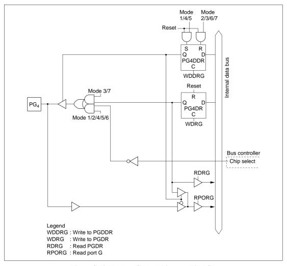
Figure C-12 (d) Port G Block Diagram (Pin  $PG_4$ )
